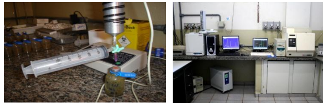
Figura 2 – Ilustração do procedimento experimental da mensuração do metano nas fezes de bovinos.
